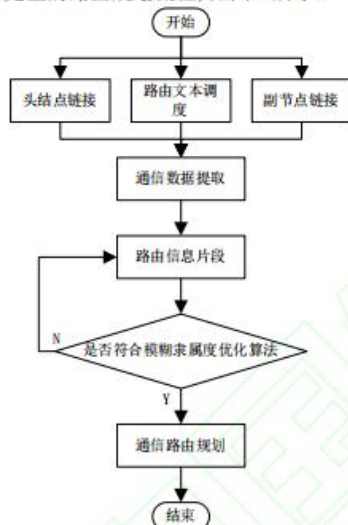
图 2 WSNs 通信路由规划流程
